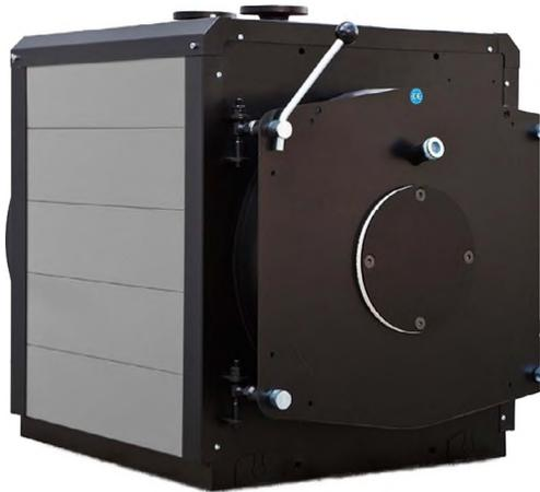
Водогрейный котел RCB 2S – стальной котел с топкой цилиндрической формы с реверсивным развитием факела, топка полностью закрыта в задней части выпуклым днищем, поддерживаемым омываемым патрубком. Котел предназначен для работы с надувными горелками на жидком или газообразном топливе. Котел спроектирован для тепловых сетей с температурой воды от 60 до 110°C.
