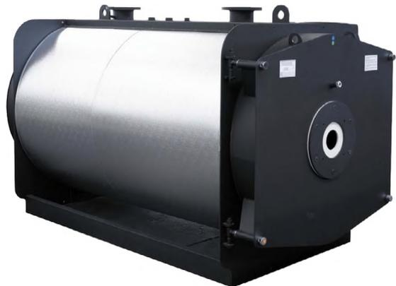
Водогрейный стальной котел модели RCB 2S с топкой цилиндрической формы с реверсивным развитием факела, топка полностью закрыта в задней части выпуклым днищем, поддерживаемым омываемой трубной опорой.
